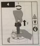
· Sujete el tornillo del manguito con una mano, gire la lámpara en sentido antihorario y tire de la extraerla de la cámara.
