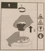
Afloje el tornillo del manguito y extráigalo con cuidado de la parte superior de la cámara.
