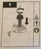
· Inserte la lámpara nueva en el manguito de cuarzo y la tuerca en el tornillo del manguito hasta que haga tope
