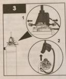
· Retire el conector de la lámpara tirando de las lengüetas y, después, hacia arriba
